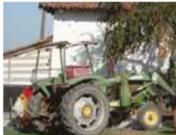
Trator com barras de prevenção de capotamento
